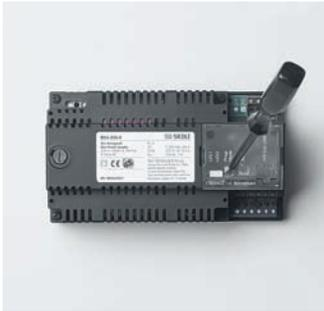
2. Sur le bloc d'alimentation bus, il appuie pendant cinq secondes sur la touche de programmation. Le système est maintenant en mode programmation.
